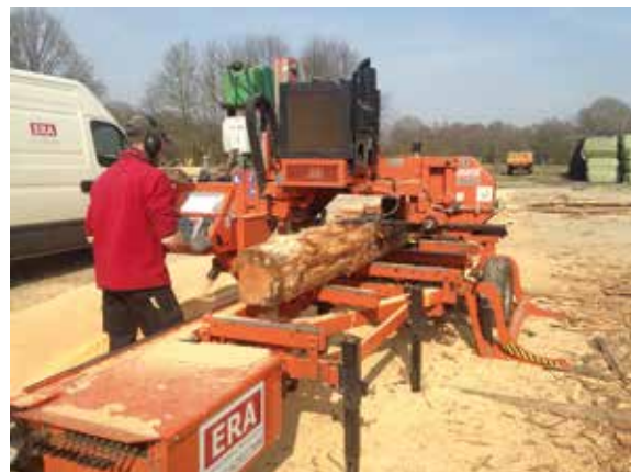
Stammen van de douglasspar zijn met een mobiele zaaginstallatie verzaagd tot balken en planken voor verwerking in eigen bouwprojecten zoals de Oude Pastorie (Beek) en Hoogcruts (bij Noorbeek). Foto Bart van der Linden.
